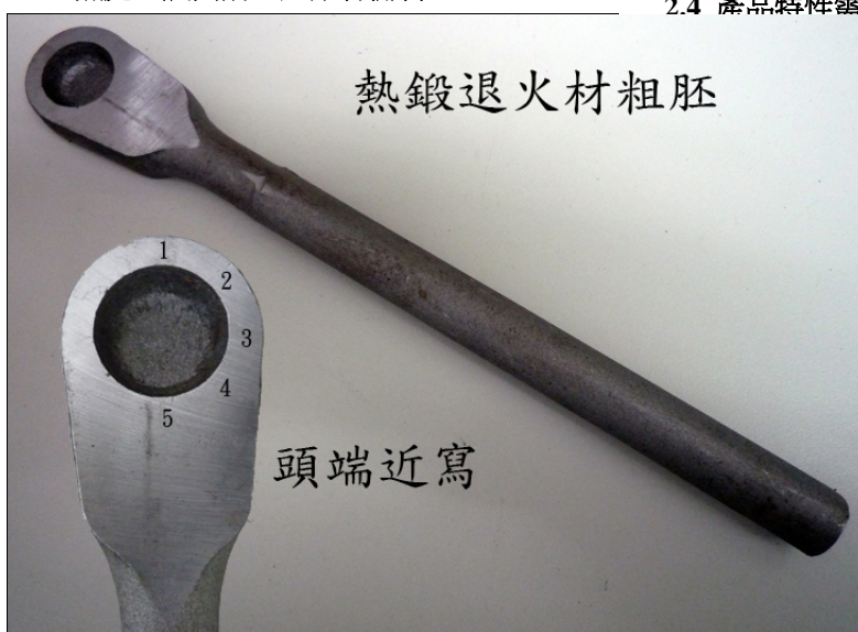
圖 1 熱鍛退火材經研磨壓平之粗胚試棒
