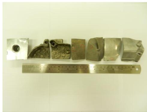
圖 2 ADC12 鋁合金壓鑄件經 460°C ~560°C 熱處理後之
